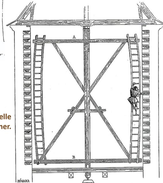
Détail de l'axe et des pivots de l'échelle permettant à celle-ci de tourner.
